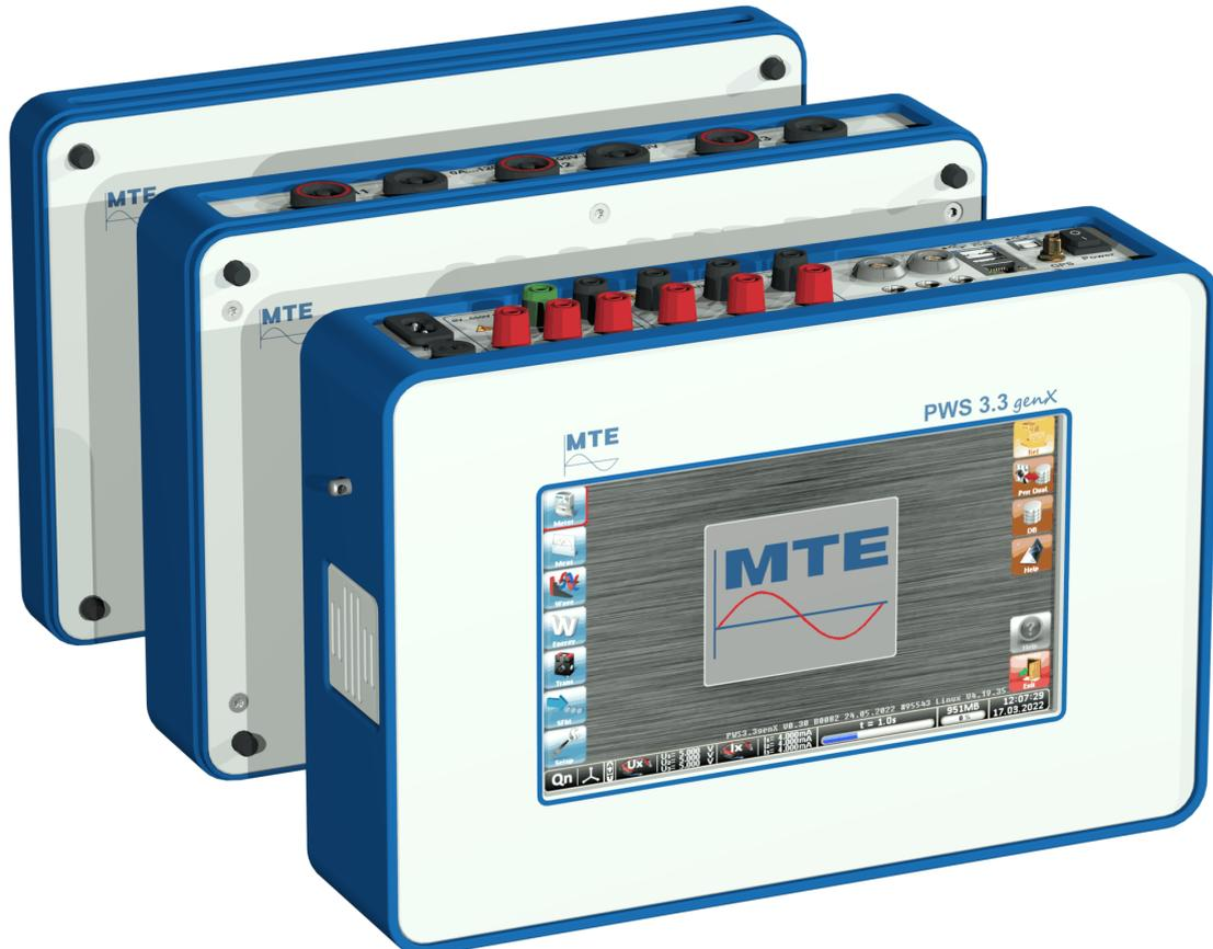
Der PWS 3.3 genX ist eine Kombination von einem dreiphasigen Arbeitsnormal der Klasse 0.05 % und einem IEC 61000-4-30 Klasse A kompatiblen Netzqualitätsanalysator mit 4 Spannungs-kanälen (U1, U2, U3, UN, UPE) und 4 Stromkanälen (direkt: I1, I2, I3 und via Stromzange: IN / IPE Nullleiter- / Schutzleiterstrom).
